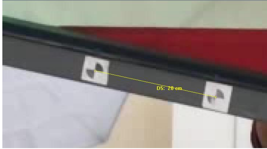
Şekil 3.8. Metrik kalibrasyon amacıyla yapıştırılan referans kağıtlar
