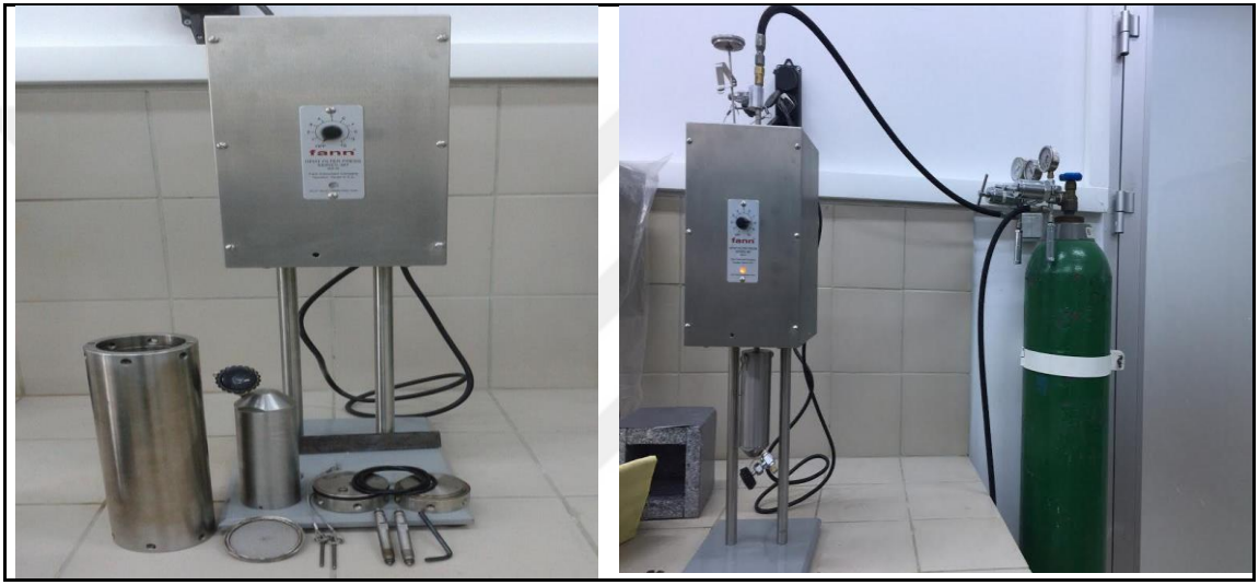
Şekil 3.7. API Yüksek Sıcaklık Yüksek Basınç Filtre Presi ölçümden önce parçaları ile birlikte ve ölçüm esnasındaki görünümü
