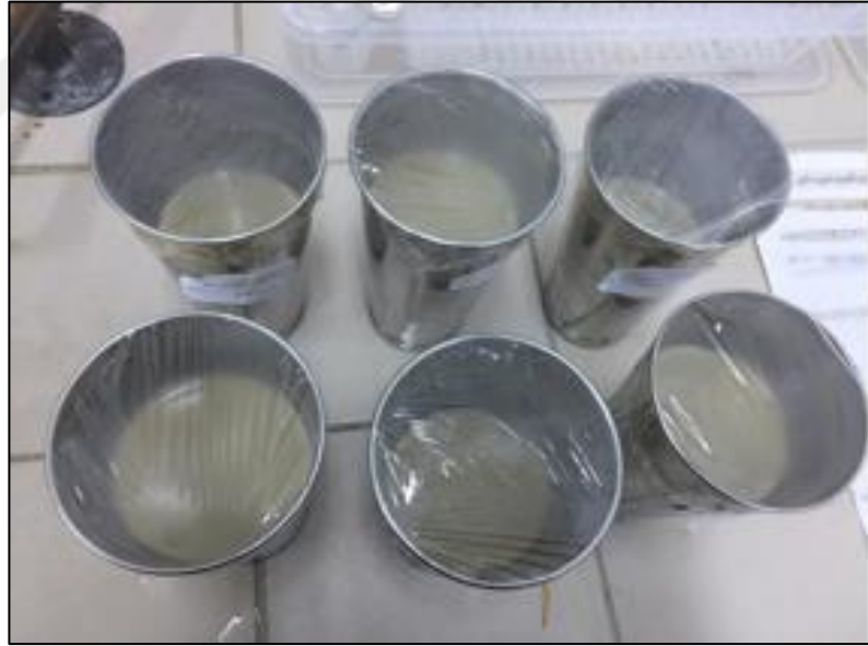
Şekil 3.10. Çamur numunelerinin yaşlandırılması
