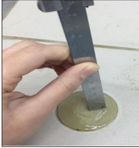
Şekil 3.11. Çamur kek kalınlığı ölçümü
