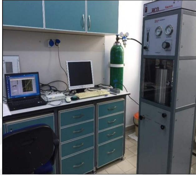
Şekil 3.3. Fann Model 50 SL Reometre
