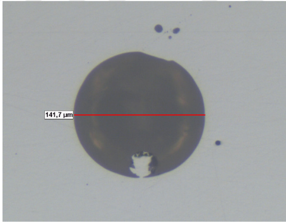
Şekil 4.2. Tespit edilen inklüzyonlara ait optik mikroskop görüntüsü (X100)
