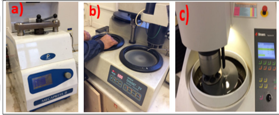
Şekil 3.13. a) Bakalitleme; b) zımparalama; c) parlatma
