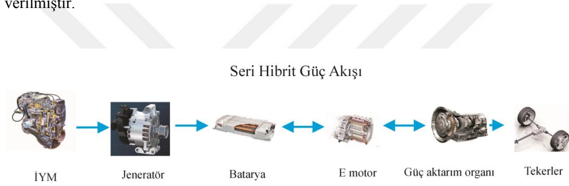
Şekil 1.1. Seri hibrit elektrikli araç mimarisi
