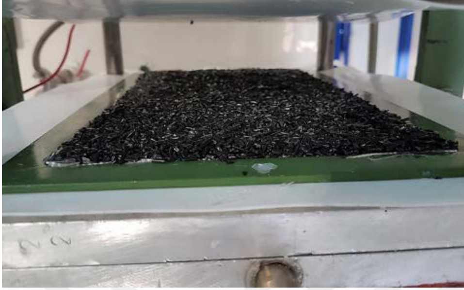
Resim 4.22. Üretime hazır hale gelen KNT katkılı YYPE ve cam elyaf
