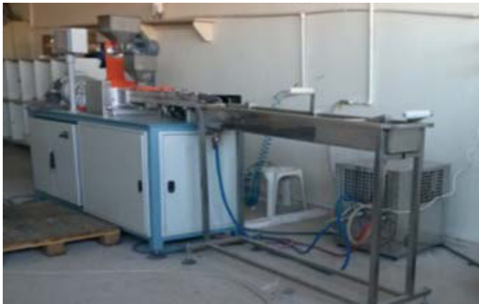
Resim 4.16. Çift vidalı ekstruder cihazı
