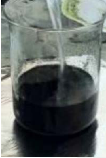
Resim 4.12. YYPE ve KNT karışımına aseton eklenmesi
