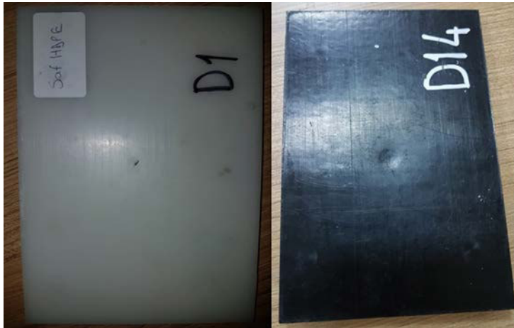
Resim 5.3. Düşük hızlı darbe deneyinde kuvvet etkisi altında kalan numuneler
