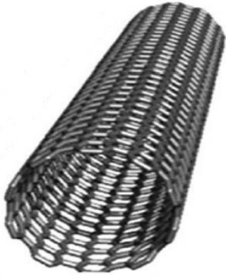
Resim 4.7. TDKNT şematik yapısı [15]
