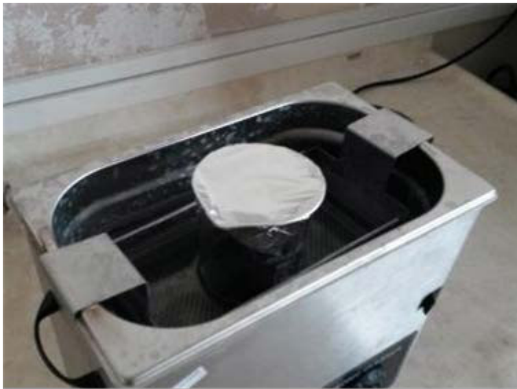
Resim 4.13. YYPE ve KNT'nin ultrasonik karıştırıcıda karıştırılması
