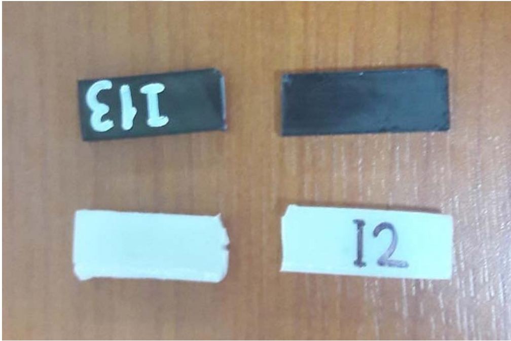
Resim 5.2. Çentik noktalarından kırılmış izod numuneleri
