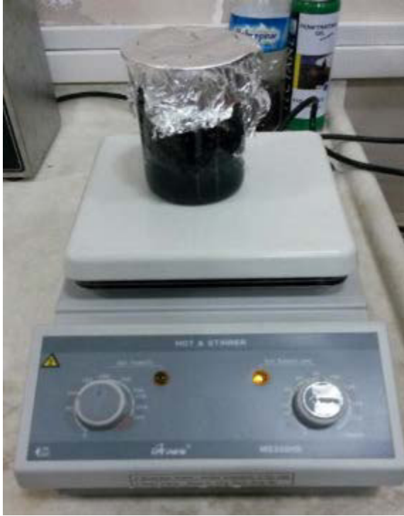
Resim 4.14. YYPE ve KNT'nin manyetik karıştırıcıda karıştırılması
