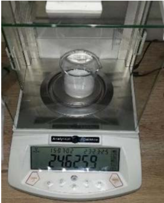
Resim 4.11. Hassas terazi ile tartım işlemi
