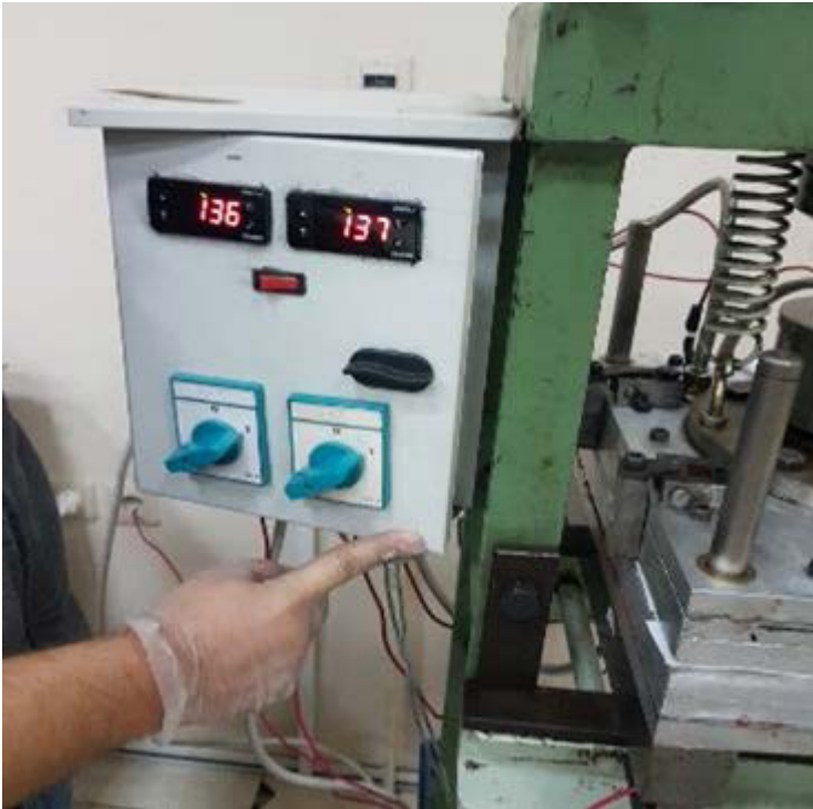
Resim 4.24. Üretim sırasında sıcaklık kontrolü
