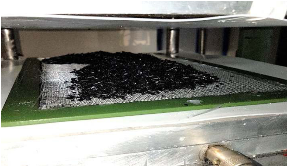
Resim 4.21. KNT katkılı YYPE ve cam elyafın kalıba yerleştirilmesi
