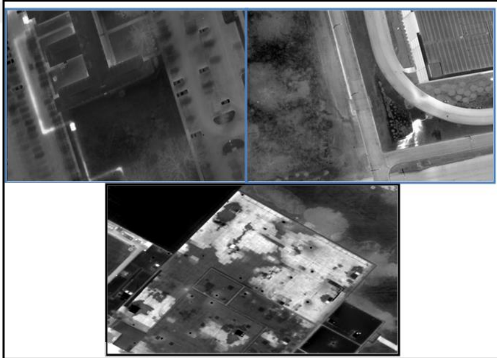
Şekil 2.1. Tipik buhar sistemi ısı kayıpları buhar borusu çatısının termal görüntüsü, ıslak zeminler, zemin sızıntısı, bir apartman yüzey üzerinde açık renkli (Stockton, 2003).
