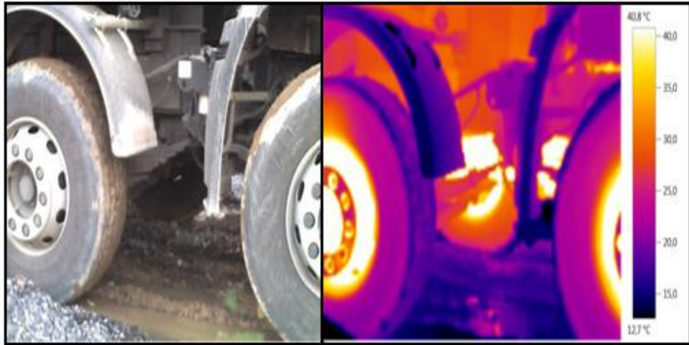
Şekil 4.37. Çalışma anında çekilen bir iş makinesinin fazla ısınan kısımları
