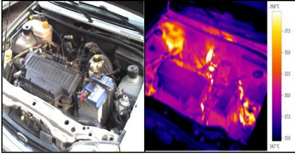
Şekil 4.39. Bir aracın motorunun çalışma esnasındaki termal görüntüleri
