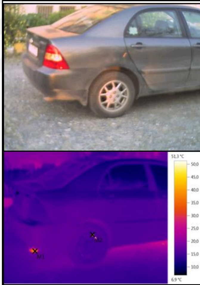
Şekil 4.40. Yerinde çalıştırılan bir otomobile ait termal ve gerçek görüntü
