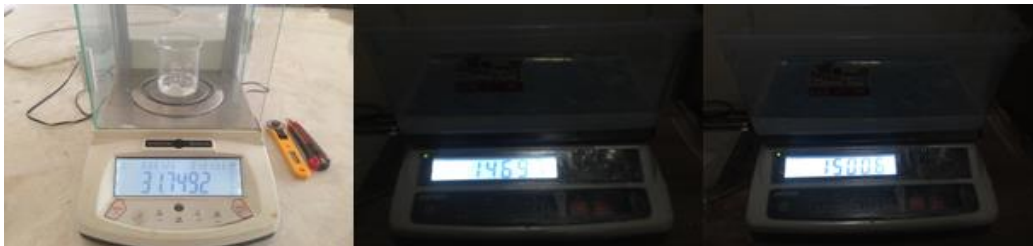
Resim 10. %1 NaOH çözeltisi hazırlama işlemi
