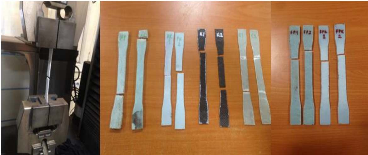
Resim 14. Deney sonu kopmuş çekme numuneleri
