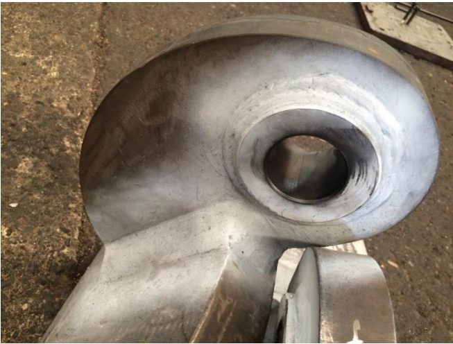
Resim 4.51. Yönlendirme aparatına manyetik test uygulaması (EK-3)
