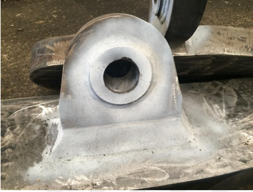
Resim 4.55. Ana kaldırma aparatına manyetik test uygulaması (EK-2)
