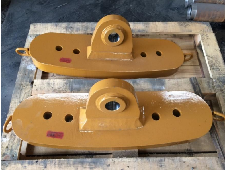
Resim 4.56. Boyandıktan sonra ana kaldırma aparatı
