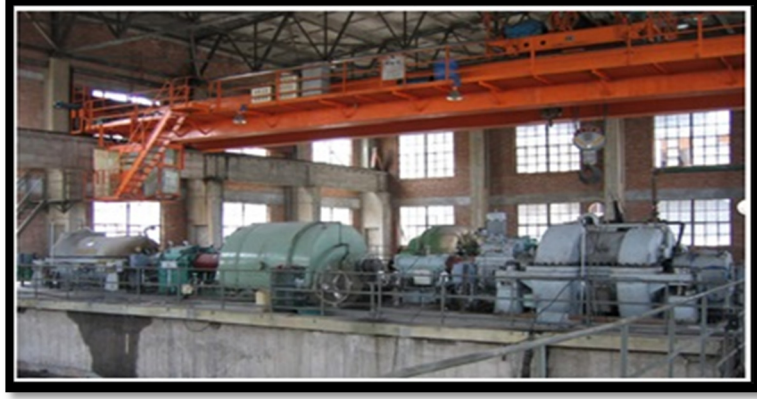
Şekil 3.4. 380 m 3 hacimli bir Yüksek Fırın için kurulmuş TBT sistemi (Anonim, 2009a)
