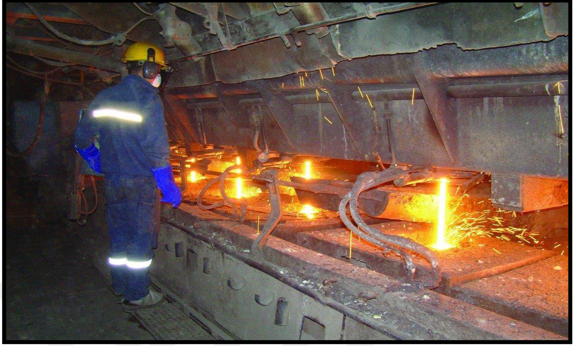
Şekil 3.3. Tandış içerisindeki çeliğin kalıplara dökülmesi
