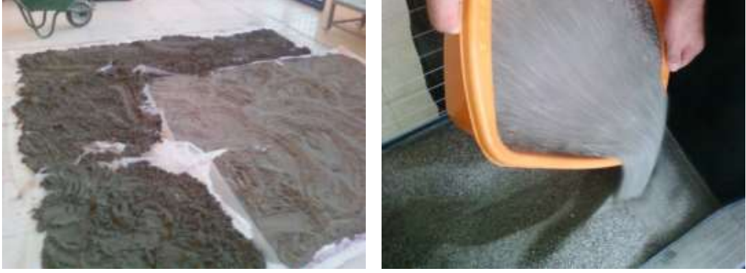
Şekil 3.2. Kumun kurumaya bırakılması, deney kasasına doldurulması
